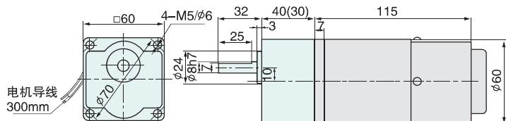
结构: 减速器+电动机+刹车器+调速器
