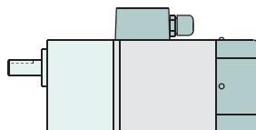
整体结构: **减速器** + **电动机** + **附件**
