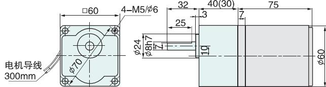
结构: 减速器+电动机
