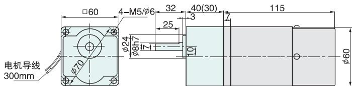
结构: 减速器+电动机+刹车器
